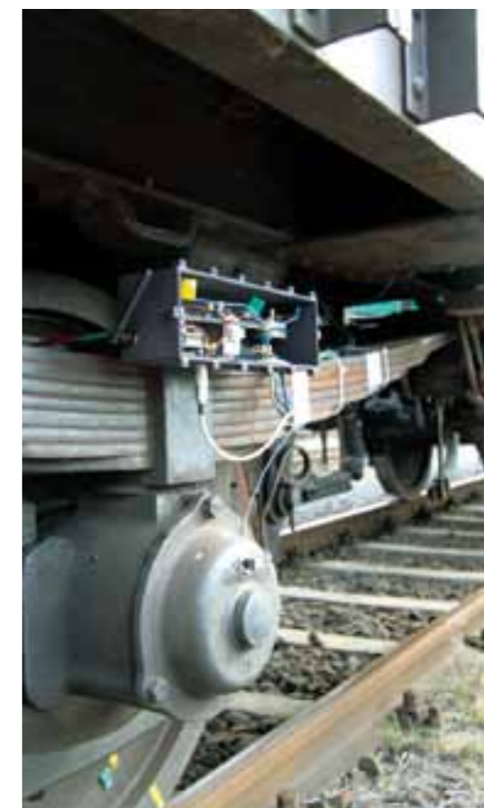
Energieautarkes Sensornetz – Validierung an einem Schienenfahrzeug über eine Messfahrt zwischen Lorsch und Worms
