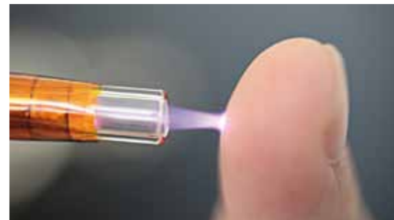
Sonde einer Helium-Niedertemperaturplasma-Ionenquelle für den Nachweis von Substanzen auf beliebigen Oberflächen. Gut erkennbar ist der blau leuchtende Strahl des Plasmas, das mit seiner Energie die nachzuweisenden Moleküle von der Haut ablöst und ihnen eine elektrische Ladung gibt, dabei aber für die Person völlig schmerzfrei und unschädlich ist. Quelle: LOEWE-Schwerpunkt AmbiProbe
