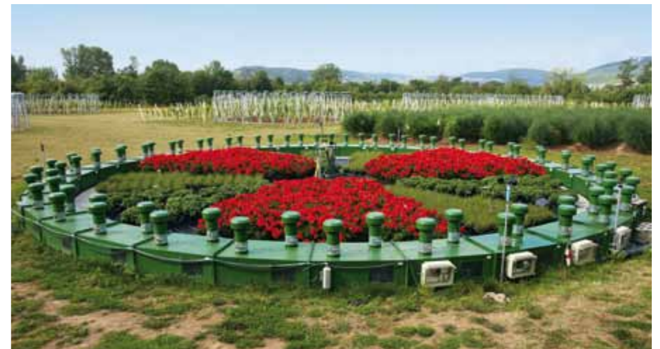
FACE für Sonderkulturen an der Forschungsanstalt Geisenheim. Im Vordergrund werden erste Versuche mit der CO 2 -Begasung von Zierpflanzen gefahren. Im Hintergrund ist der Aufbau von FACE-Ringen für mehrjährige Kulturen (z. B. Apfel, Reben) zu sehen.
