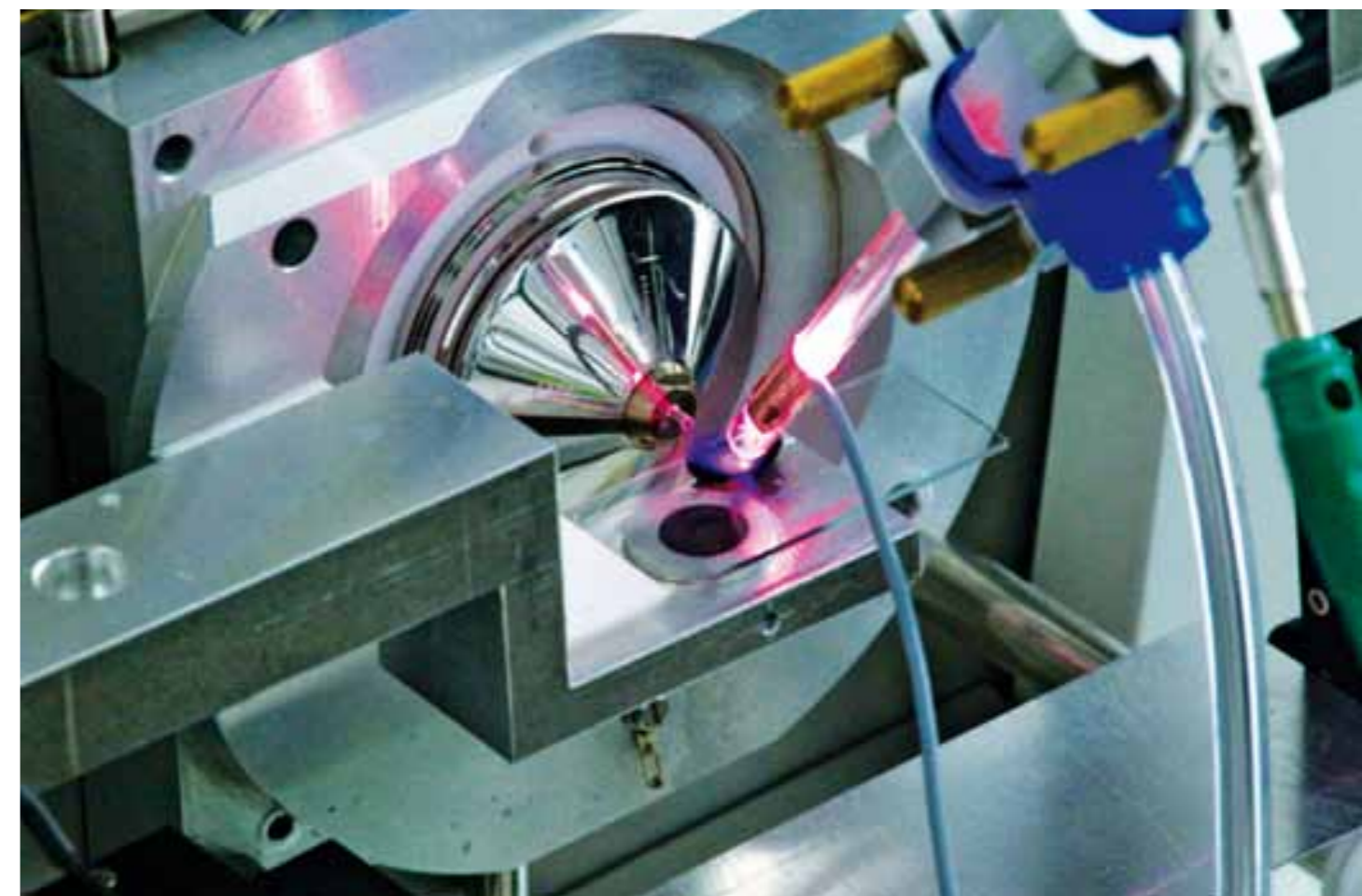
Die „low temperature plasma (LTP)“-Methode erzeugt einen kalten und energetischen Gasstrom, der an lebenden Objekten für den direkten Nachweis von oberflächhaftenden Substanzen eingesetzt werden kann.
