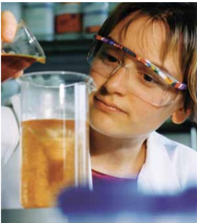
Fällung von magnetischen Nanopartikeln im Labor. Sie sind eine der drei wichtigen Komponenten bei einer neuartigen Klebetechnologie mit Mikrowellen.
