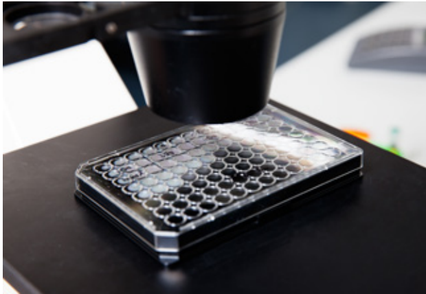
Eine Platte mit 96 Reaktionsgefäßen unter dem Binoskop zur Untersuchung genetischer Schaltkreise.
